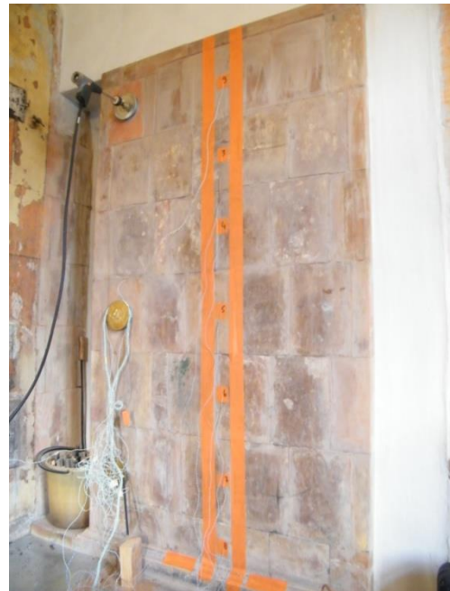
Joonis 4. Temperatuuriandurite paigutus vertikaalsihis kontrolliks ja takistustraadi kalibreerimiseks (foto K. Hovi)
