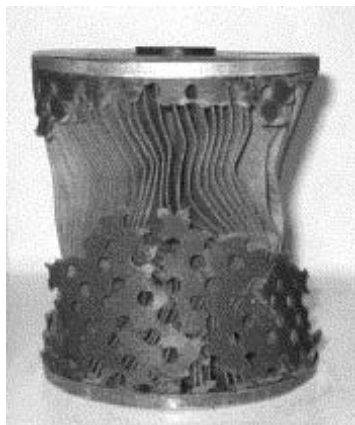
Joonis 2. Rapsiõlikütuse kasutamisel purunenud filter (Labeckas, 2005)
