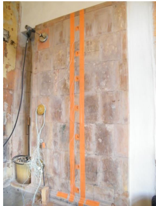
Joonis 4. Temperatuuriandurite paigutus vertikaalsihis kontrolliks ja takistustraadi kalibreerimiseks (foto K. Hovi)
