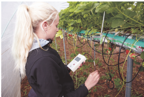
Joonis 5. Aianduse õppekava magistrant Madli Tramm mõõdab substraadi niiskust ja elektrijuhtivust taasviljuvate maasikate katses Aran PM OÜ tunnelkasvuhoones
