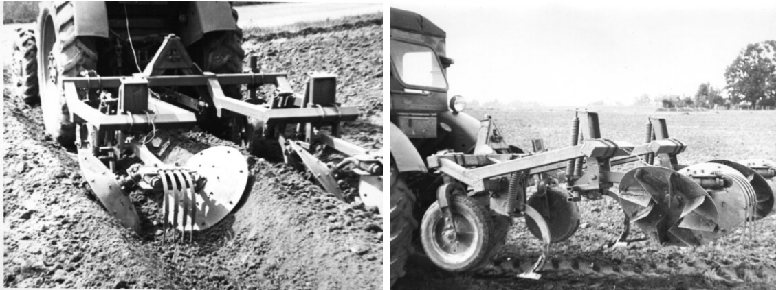
Joonis 1. J. Oldi konstrueeritud ja ehitatud laiarealise kartulipõllu reasharimise põimmasin Figure 1. The combined wide rows potato field processing machine, constructed by J. Olt
