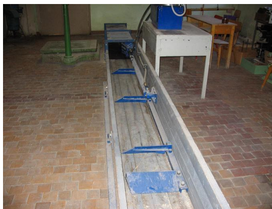
Joonis 5. Katsetamise eesmärgil laborisse V. Veinla töögrupi poolt paigaldatud sõnnikupressur
