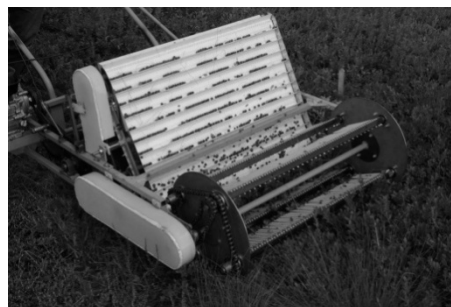
Joonis 2. Motoplokk-tüüpi mustikakoristi põhisõlmed ja osad: a – põhimõtteskeem, b – eestvaade masinale; 1 – mootor, 2 – ülekanne, 3 – korjehaspl, 4 – konveier, 5 – marjasuunur, 6 – marjakast, 7 – kopeerseadis, 8 – raam, 9 – juhthoovad, 10 – veermik, 11 – haspli völli, 12 – korjekamm, 13 – varbpiid, 14 – konksjas vedrupi
